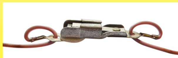
Ограничитель температуры нагревательного одеяла Calor с медленным разрывом, откалиброванный на 80°C (около 1960 г.). Обратите внимание на водонепроницаемую PVC втулку, приваренную к проводам, и петлю, сделанную электрическими проводами, проходящими через отверстие в каждой клемме - это сделано для устранения растягивающих напряжений на проводах (коллекция Ultiheat)
