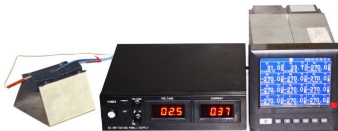
Оборудование для измерения температуры поверхности в зависимости от поверхности Вт/см 2 нагревателя одеяла или нагревателя рубашки
