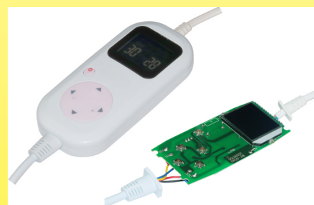
2019 Блок управления для терморегулируемых нагревательных одеял с цифровой индикацией через терморезисторный зонд, встроенный в обогреваемую зону (Ultimheat Collection)
