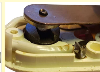
1972 г. Блок управления мощностью, изготовленный компанией Jidé в Лиможе под маркой Jidéstat. Самая успешная из всех систем. Очень маленькая по размеру, она регулируется и встроена в электрическую вилку. Это единственная модель с защелкивающимся магнитным контактом. Она не была превзойдена электромеханическими системами вплоть до нынешней эпохи. (Коллекция Ultimheat)
