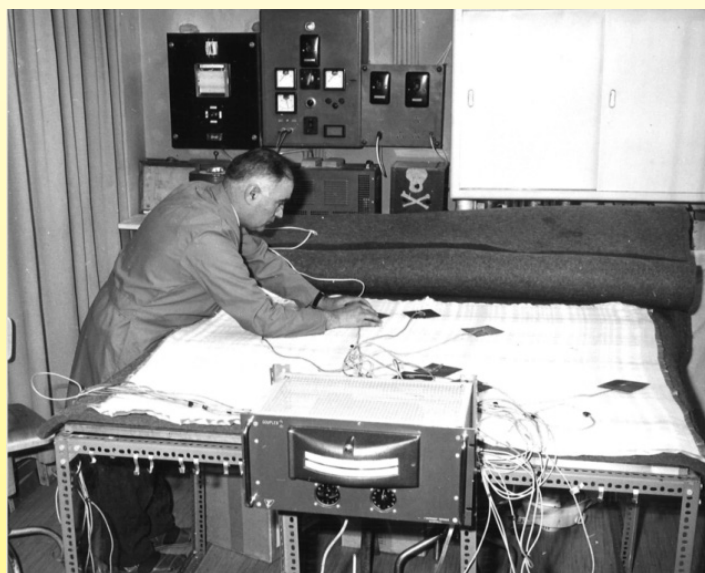
Измерение температуры поверхности нагретого одеяла (1960 г, Vedette, Музей Ultimheat)
