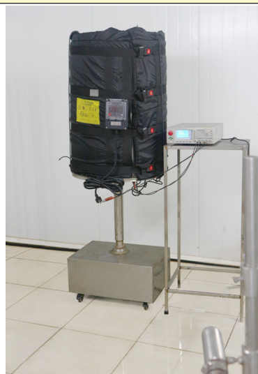
Измерение сопротивления изоляции после испытаний IPx6
